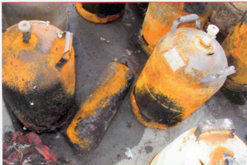
Bild 3: Die Flüssiggasflaschen haben zum Teil Dehnungsrisse.
